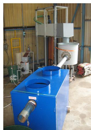
Banc d'essai hydraulique des performances du séparateur
