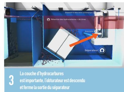
Saint Dizier Environnement a retenu un dispositif composé d'un ensemble flotteur - tige - clapet, répondant aux exigences d'étanchéité du dispositif d'obturation automatique défini dans la norme EN 858-1 à savoir une fuite inférieure à 100 ml x TN sur 15 minutes.
